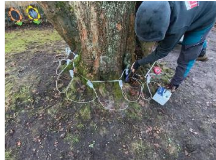
Abb. 68: Bergahorn Nr. 17 mit Schallsensoren an Wurzelanläufen
