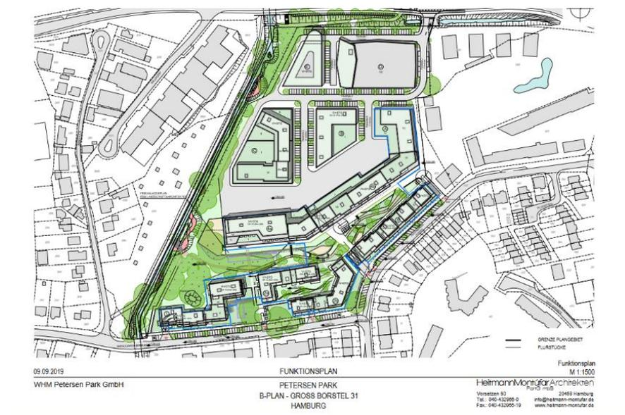
Weiterhin wurde der durch vorgesehene Bebauung innerhalb des Überschwemmungsgebiets entstehende Retentionsraumverlust durch die Schaffung eines Ausgleichsvolumens mittels der zuvor beschriebenen Maßnahmen kompensiert. Für die Einhaltung der Hochwasserneutralität wurde die Gewässerplanung durch den LSBG in einer Simulation überprüft.
